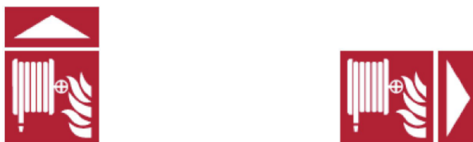
图 9 位置指示补充标志的组合标志示例(ISO 7010-F002)(带有内部边界)
