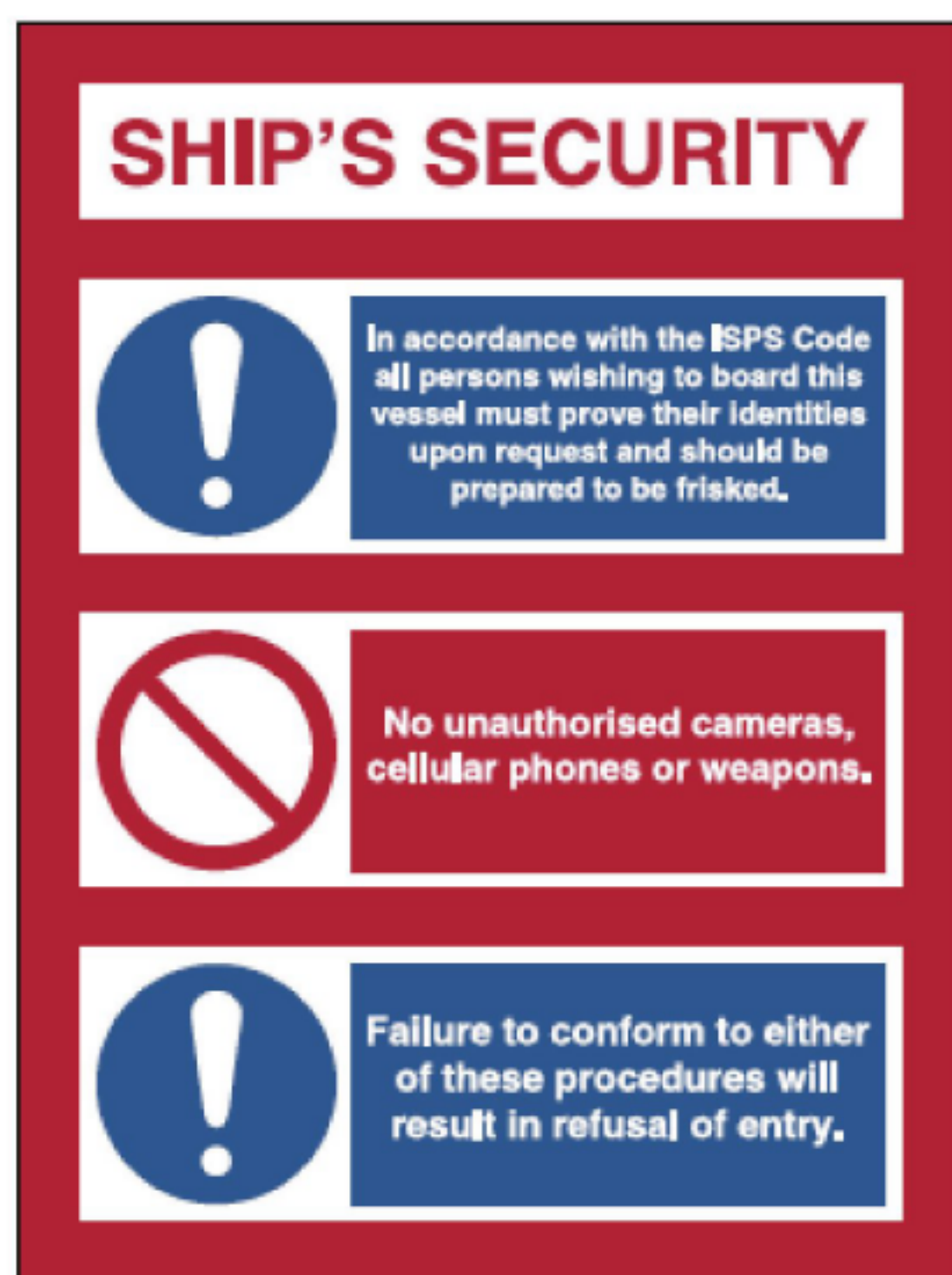
图 18 带补充文字的强制安全标志(ISO 7010-M001)和禁止安全标志(ISO 7010-P001)形成的多重标志示例
