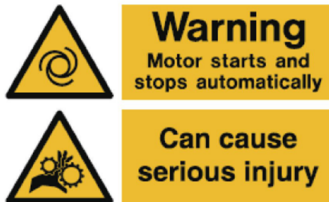
图 12 图形(危险与风险)补充标志和补充文字补充标志组成的组合标志示例
