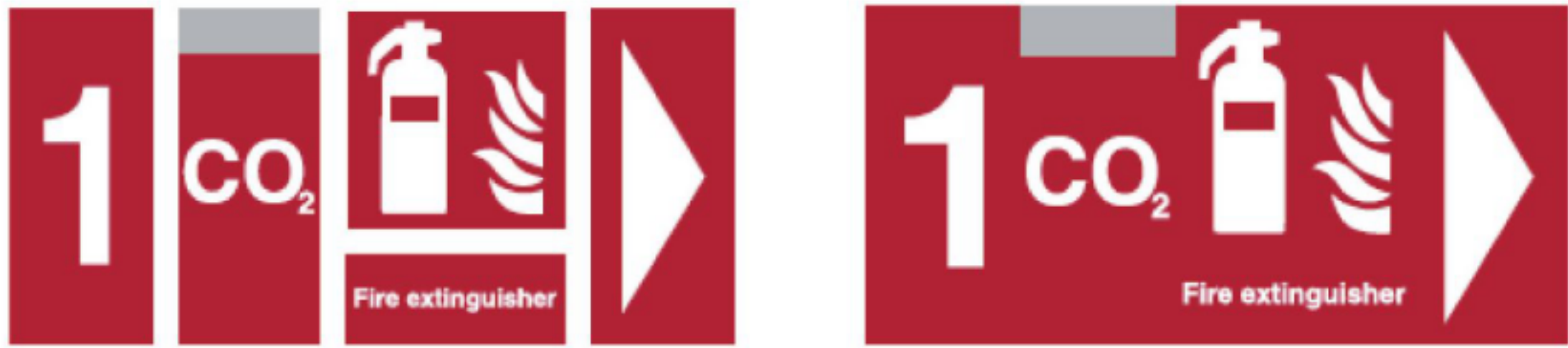
图 16 ISO 7010-F001 带有或不带有内部边界的带说明文字、识别、方向箭头三类补充标志的消防组合标志示例
