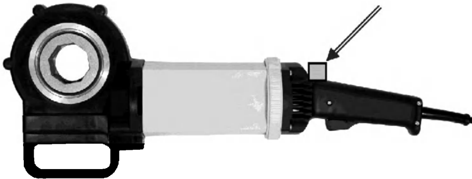
图 I.102 套丝机的传感器位置
