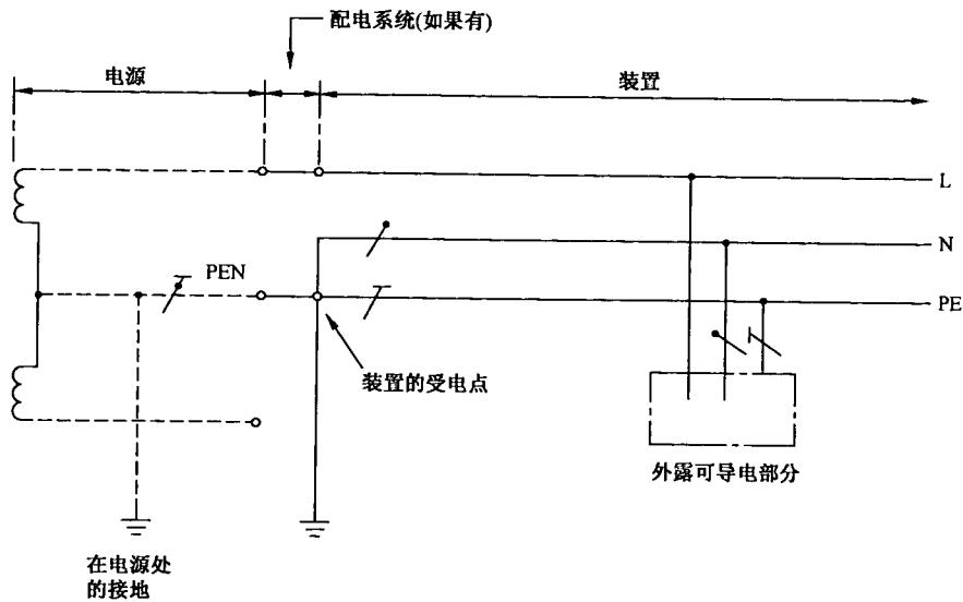
在系统的一部分中,中性导体的功能和保护导体的功能合并在一根导体中。
