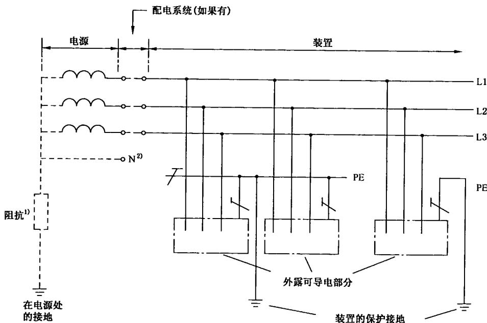
注：对装置的 PE 导体可另外增设接地。
