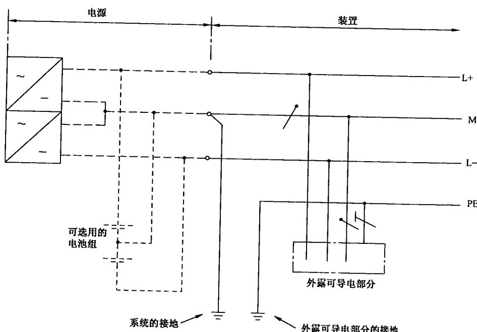
注 2：对装置的 PE 导体可另外增设接地。
