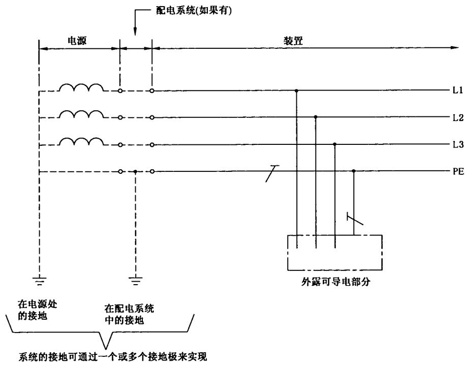
注：对装置的 PE 导体可另外增设接地。
