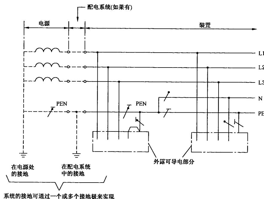
在系统的一部分中, 中性导体和保护导体的功能合并在一根导体中。
