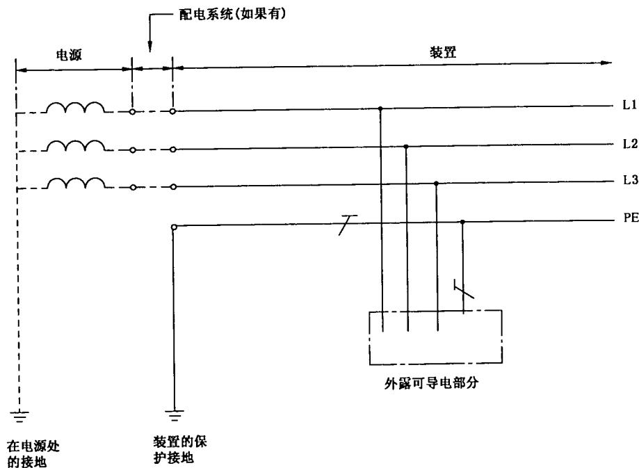
注：对装置的 PE 导体可另外增设接地。
