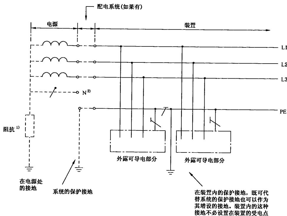
注：装置的 PE 导体可另外增设接地。
