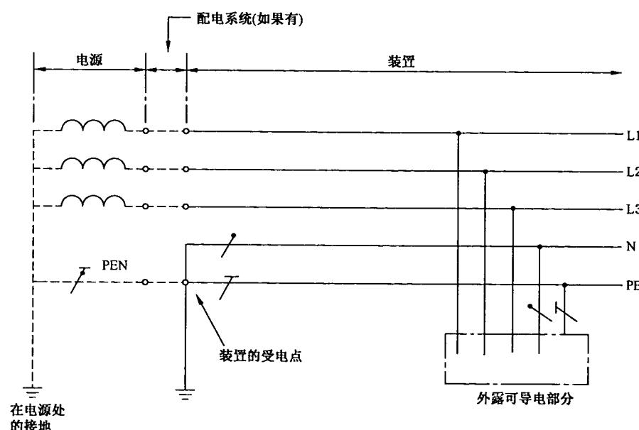
注: 对配电系统的 PEN 和装置的 PE 导体可另外增设接地。
