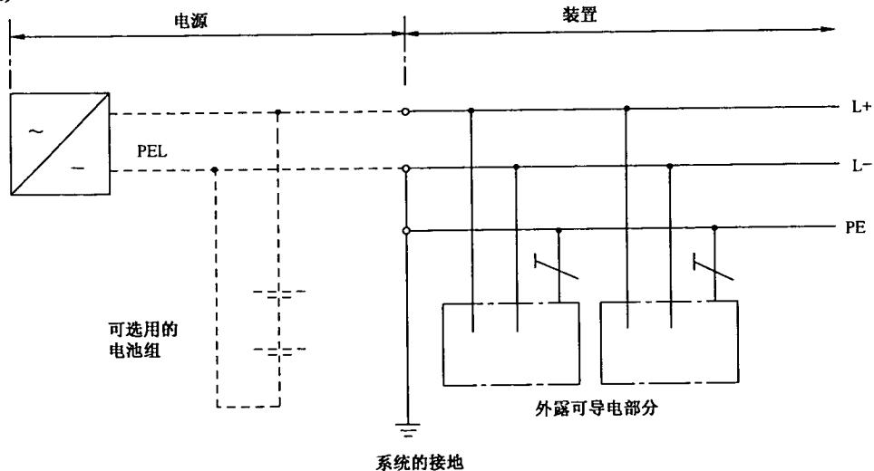
注1: 对装置的PE导体可另外增设接地。
