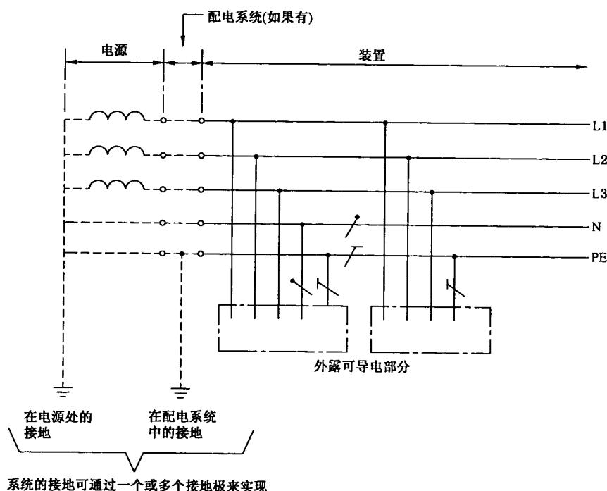
注：对装置的 PE 导体可另外增设接地。
