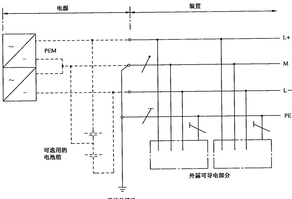
注2: 对装置的PE导体可另外增设接地。
