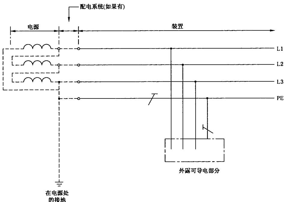
注：对配电系统和装置的 PE 导体可另外增设接地。
