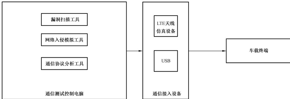
图4 车载终端信息安全通信试验示意图
