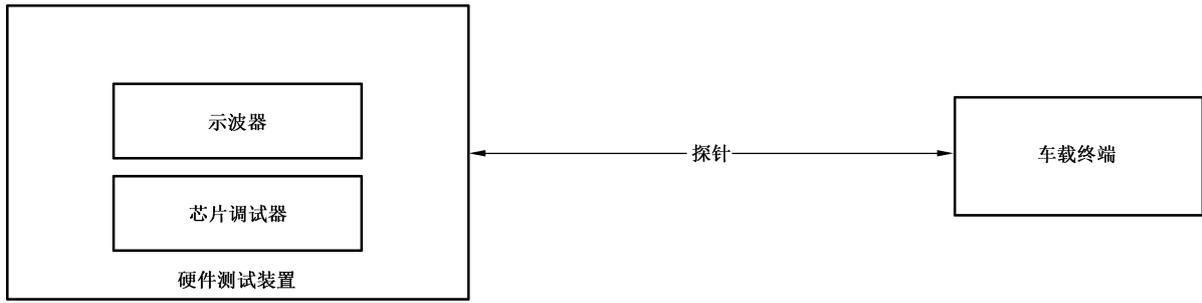
图3 车载终端信息安全硬件试验示意图
