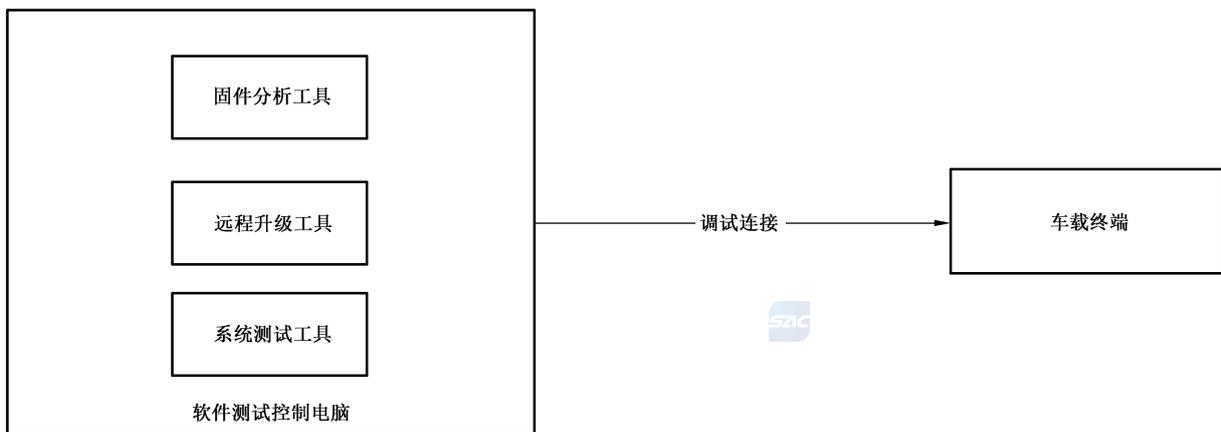
图5 车载终端信息安全软件试验示意图
