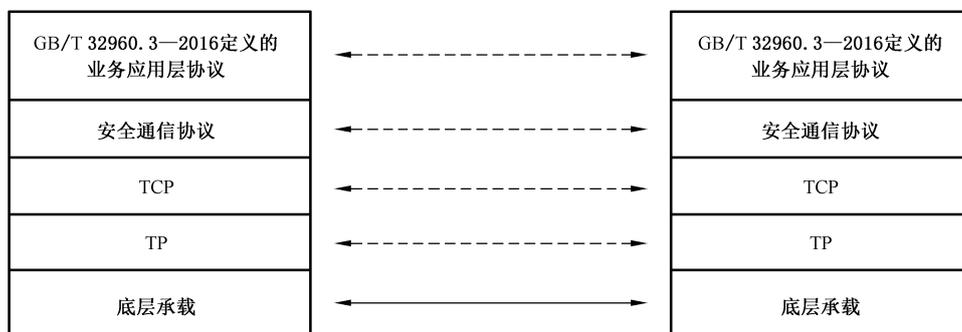
图 2 电动汽车远程服务与管理平台安全通信协议栈
