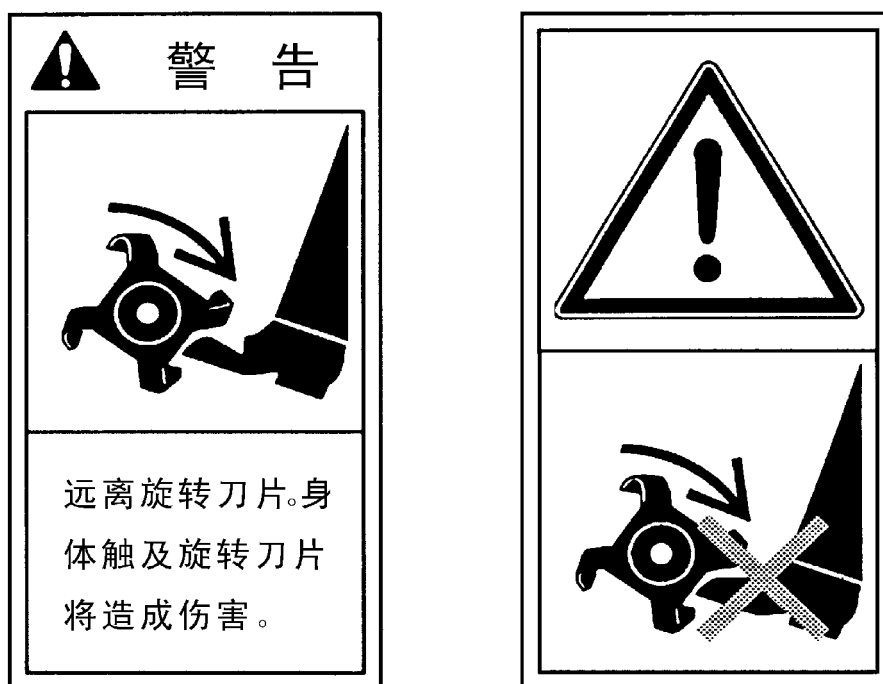
图 7 指明旋转刀片危险的安全标志示例
