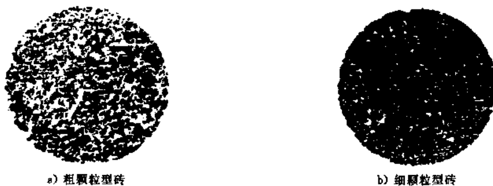
图2 合格试样的复写纸印痕
