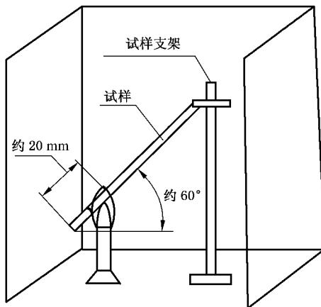
图 1 试样及喷灯位置示意图
