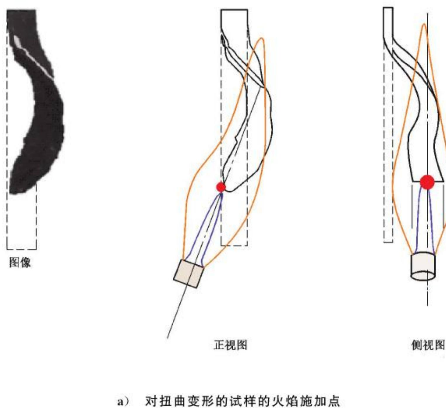
a) 对扭曲变形的试样的火焰施加点
