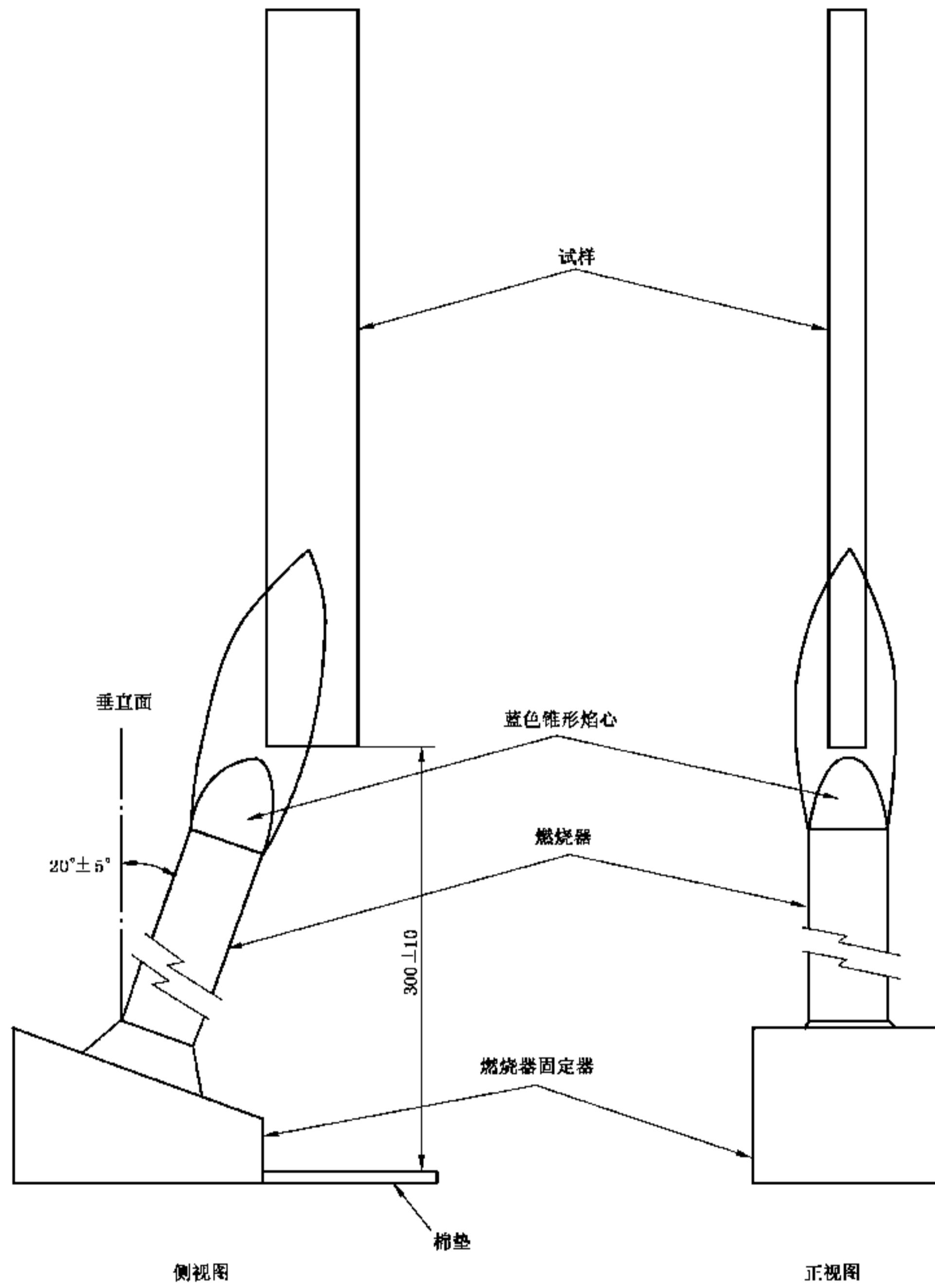
图 1 条形式样的垂直燃烧试验
