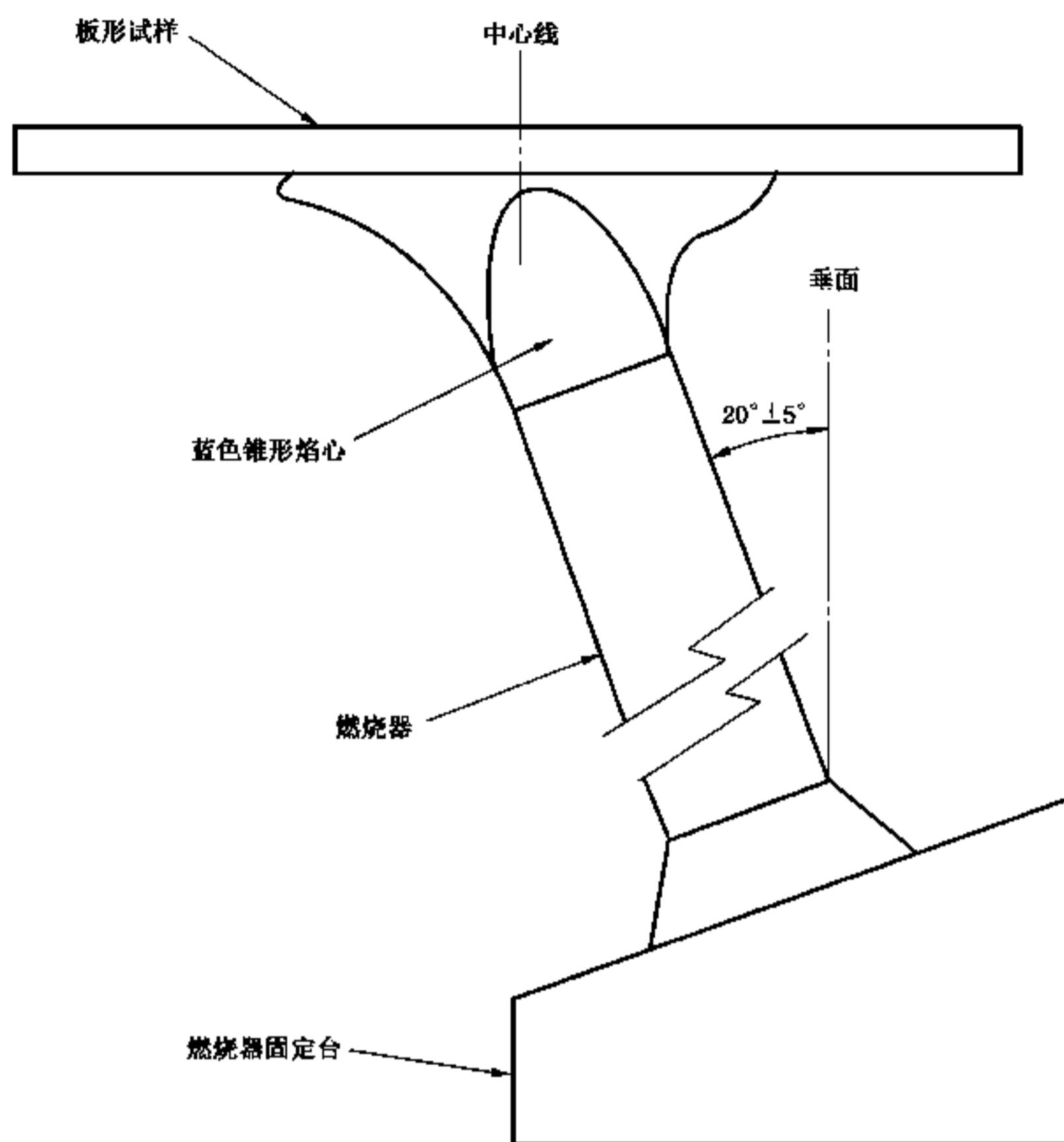
图 2 板形试样的水平燃烧试验
