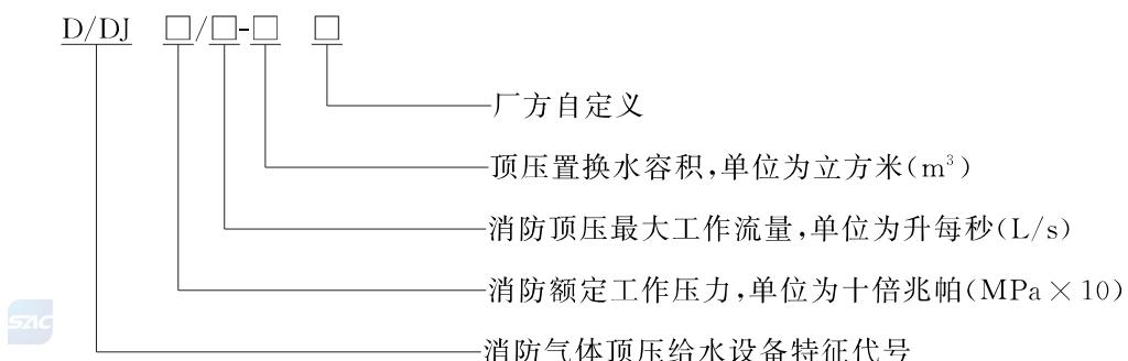
**示例 1:D 6/10-6** 表示通用型消防气体顶压给水设备,消防额定工作压力为 0.6 MPa,消防顶压最大工作流量为 10 L/s,消防顶压置换水容积 6 m<sup>3</sup>。
