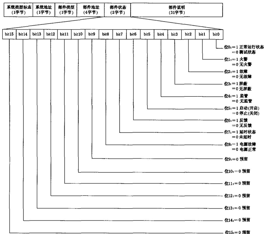
图 7 建筑消防设施部件状态数据结构
