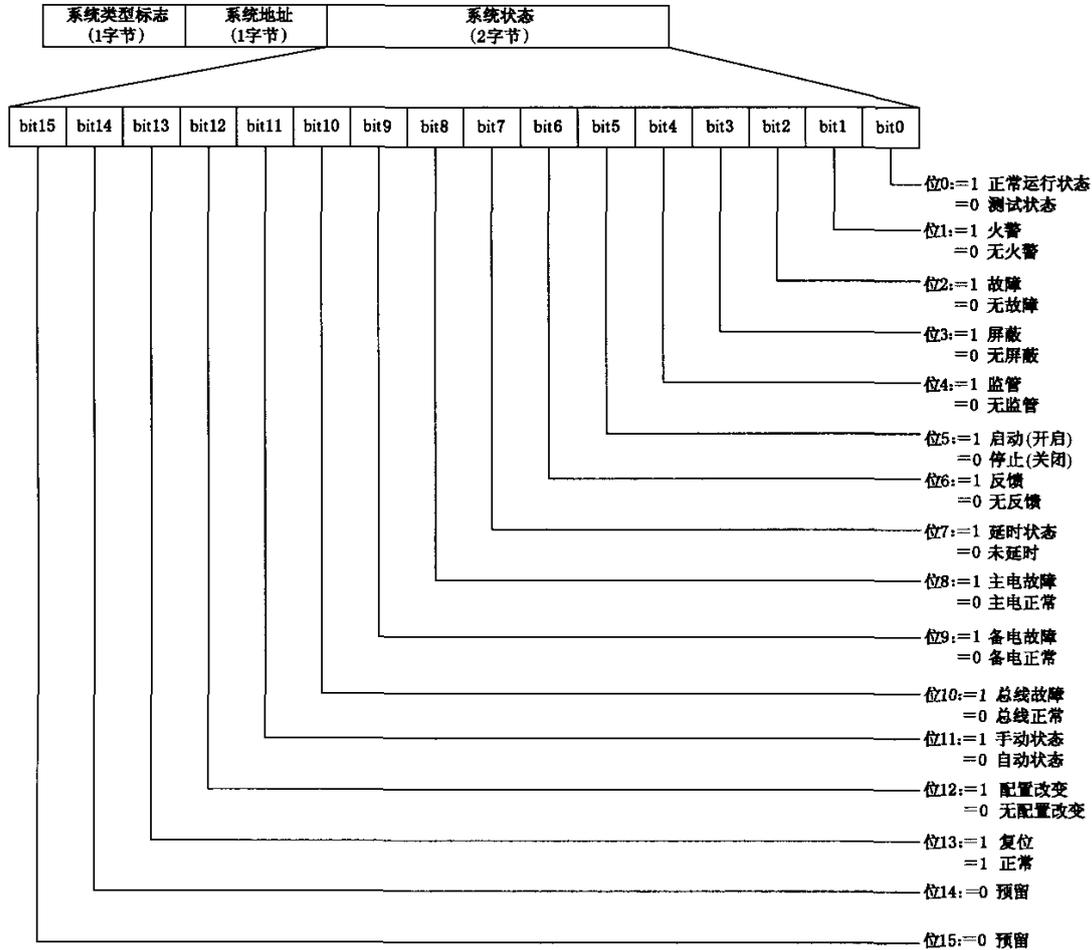
图 6 建筑消防设施系统状态数据结构
