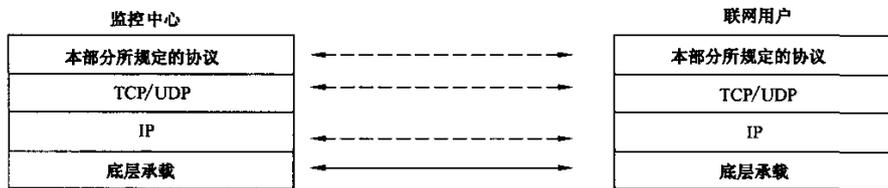
图 1 监控中心与联网用户间通信协议栈
