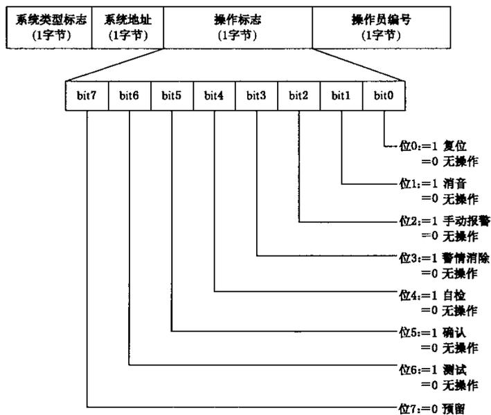
图 9 建筑消防设施操作信息数据结构
