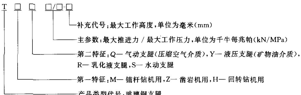
4.2 主参数中,最大推进力值以5的倍数定制;最大工作高度值圆整至十位,并以5的倍数定制。
